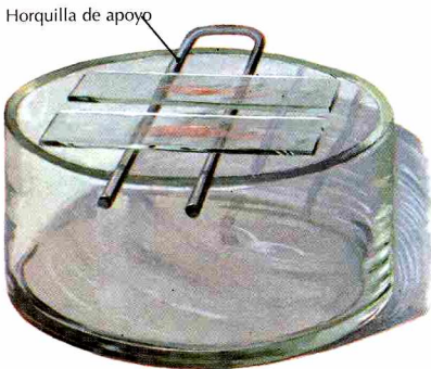
Fig. 3 – Modo de colocar las preparaciones sobre el cristalizador.
