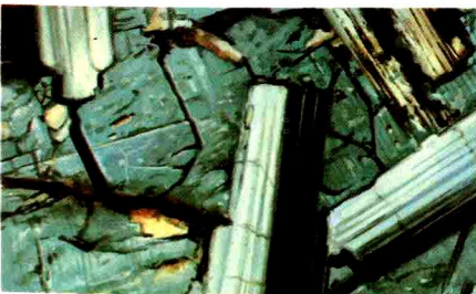
Fig. 4 - Micrografía de un gabro. Luz polarizada.
