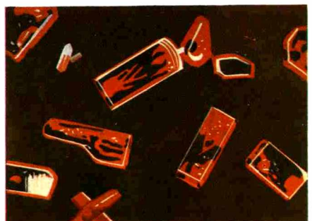
Fig. 6 – Reacción microquímica, con luz polarizada, que nos descubre pequeñas cantidades de plata.
